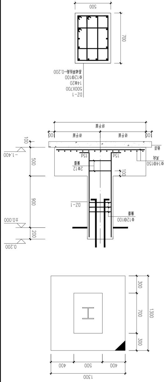
管架基础平面布置图
